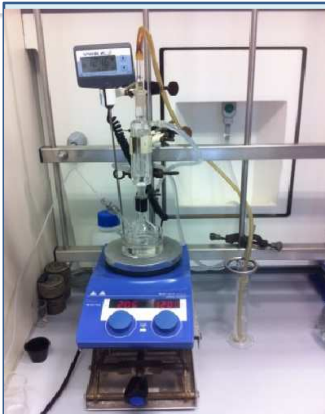
Gömbloblik visszafolyó hűtővel, fűthető mágneses keverőn
